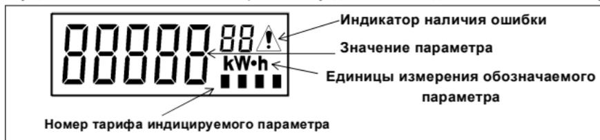
Рис. 2.1 Расположение информации на индикаторе
