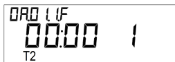
Рис. 16 Меню 8 кадр 10. Начальный кадр подгруппы. Время начала тарифной зоны 1 с указанием номера тарифа
