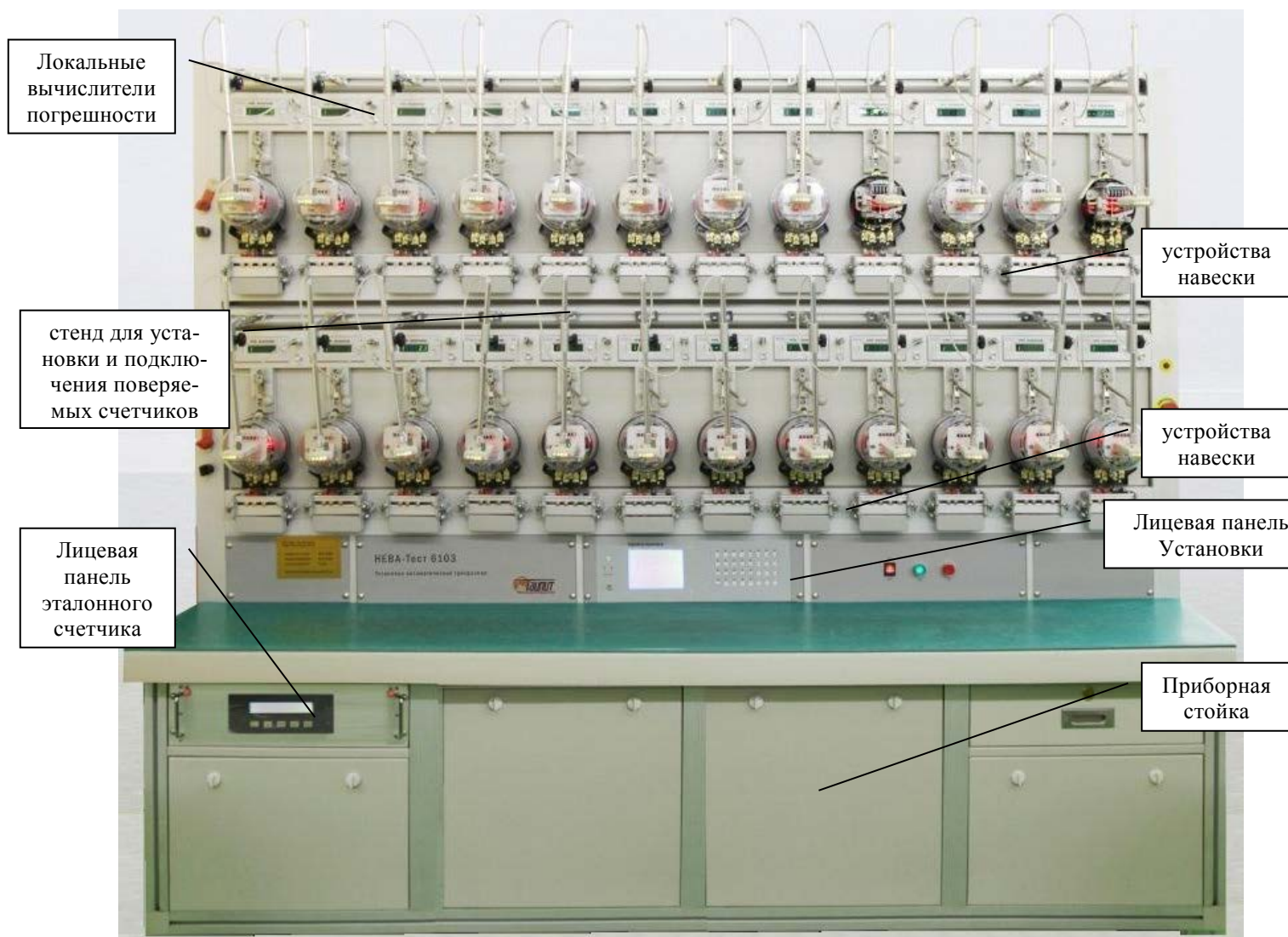
Рисунок 2.5.1 Внешний вид Установки на 24 поверочных места
