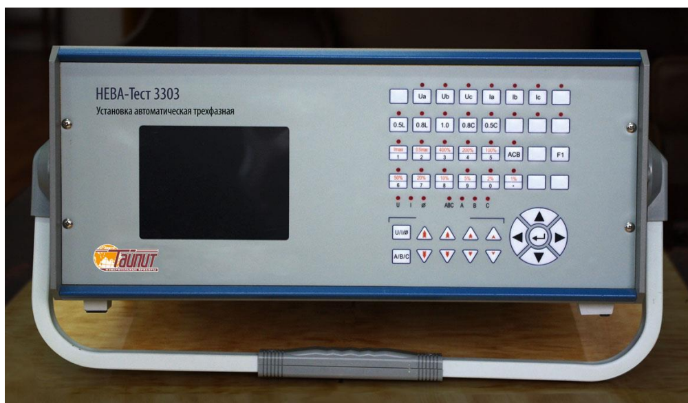
Фото 1 Установка переносная НЕВА –Тест 3303П
