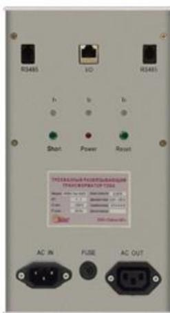
Трансформатор предназначен для гальванической изоляции последовательных цепей счетчиков электрической энергии от цепей тока поверочных установок при проверке счетчиков.
