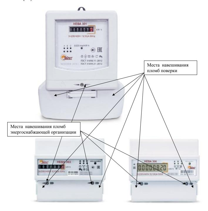
Рис.1 Счетчики электроэнергии трехфазные Нева 301, Нева 303, Нева 306 с указанием мест навешивания пломб.
