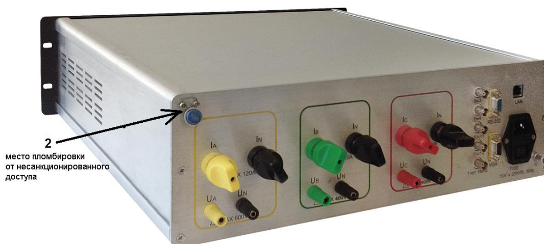
Рисунок 2 - Общий вид прибора электроизмерительного многофункционального НЕВА-Тест 9303 и место пломбировки от несанкционированного доступа
